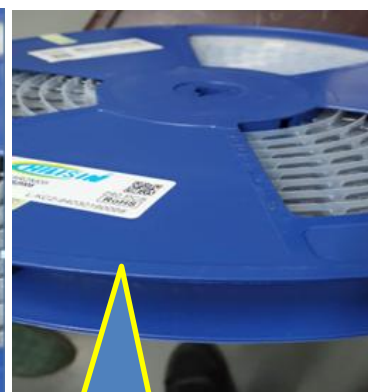
標籤貼導帶孔的反面 The position of the label
